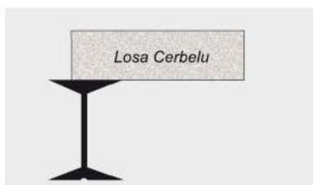
esquema de distancia de apoyo en perfil doble T.
