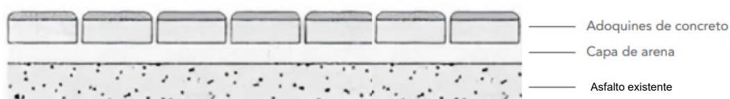
DETALLE: Esquema del paquete estructural del pavimento
